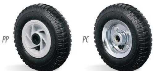
Fabricadas com pneu e câmara de ar, com núcleo em chapa de aço carbono estampado com acabamento zinckado ou nylon injetado. Indicadas para aplicações em pisos irregulares onde é necessário facilidade de movimentação e amortecimento dos impactos e vibrações. Proporcionam fácil manutenção e seus componentes podem ser fornecidos separadamente. A velocidade de trabalho indicada é até 4km/h.
